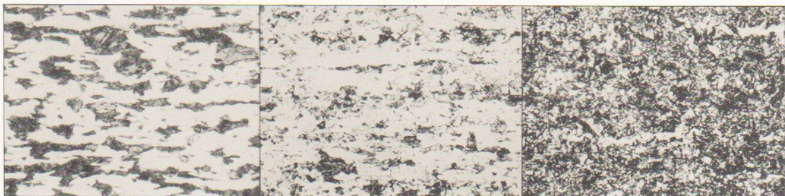
25 CrMo4: STRUTTURA INALTERATA
